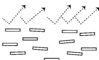
光輝材同士の感覚が詰まっていて正面の反射光(ギラツキ感)が強い時に使用します。
