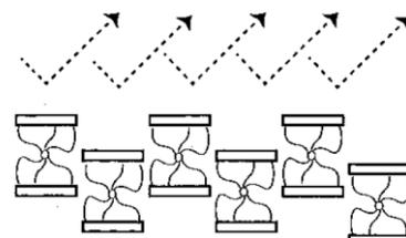
光輝材の間隔が詰まっているため、吹きムラが発生しているときに使用します。
